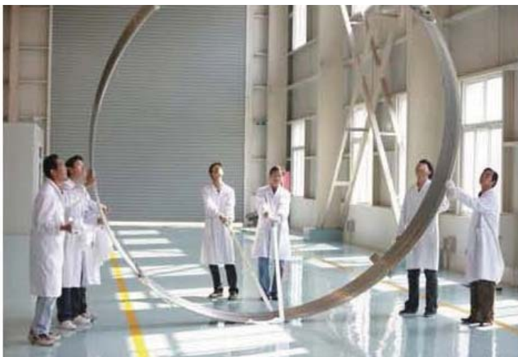
Рисунок 1. Сверхпроводящие корректирующие катушки для ИТЭР в Институте физики плазмы (Китай)
